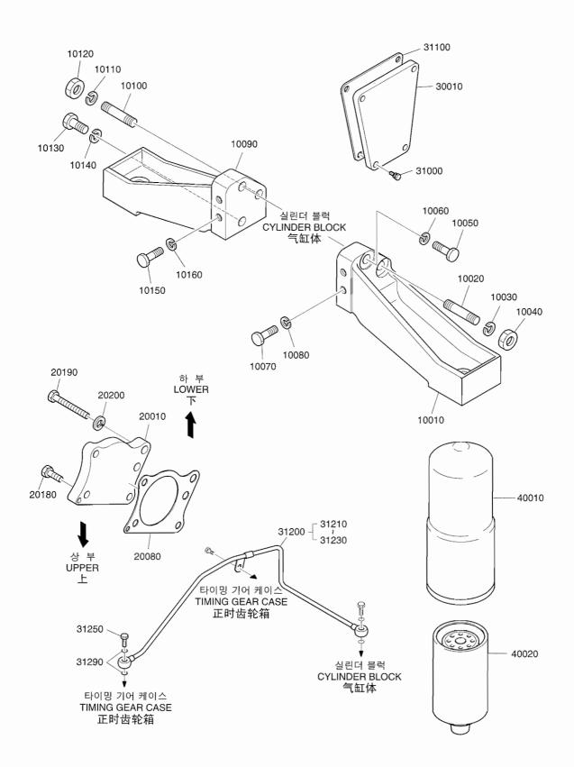
Fig.018 ENGINE MOUNTING & ETC | 엔진 마운팅 및 기타 | 发动机固定架及其它
