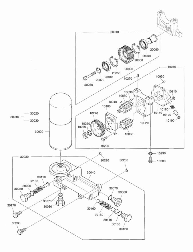
Fig.006 OIL PUMP & OIL FILTER | 오일 펌프 및 오일 휠터 | 机油泵与机油滤清器
