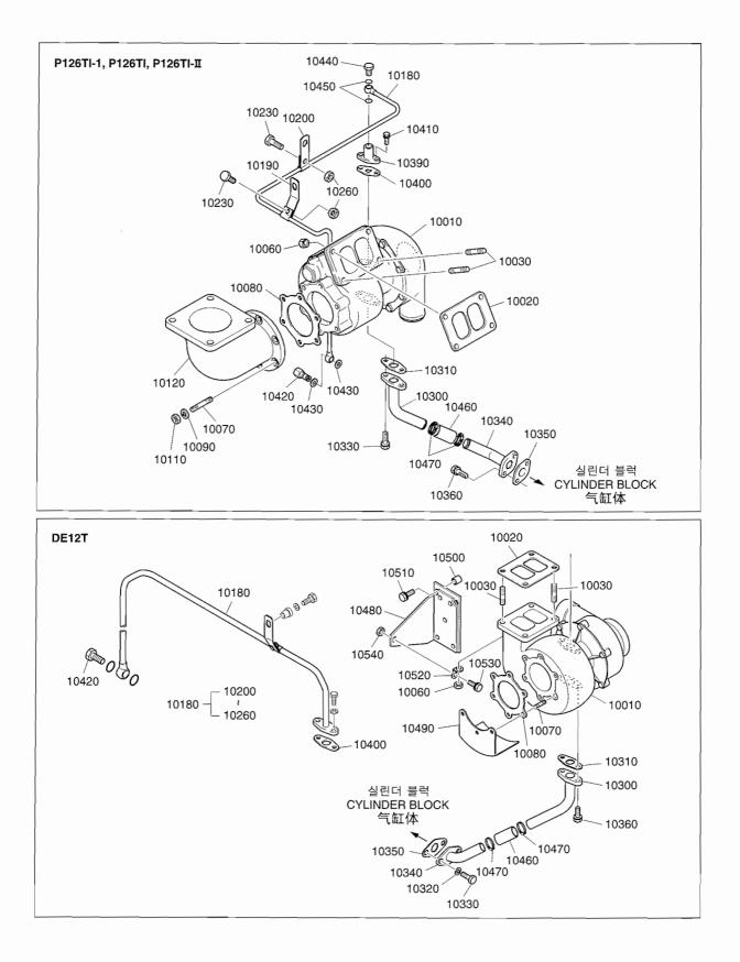
Fig.013 TURBO CHARGER | 터보 챠저 | 涡轮增压器
